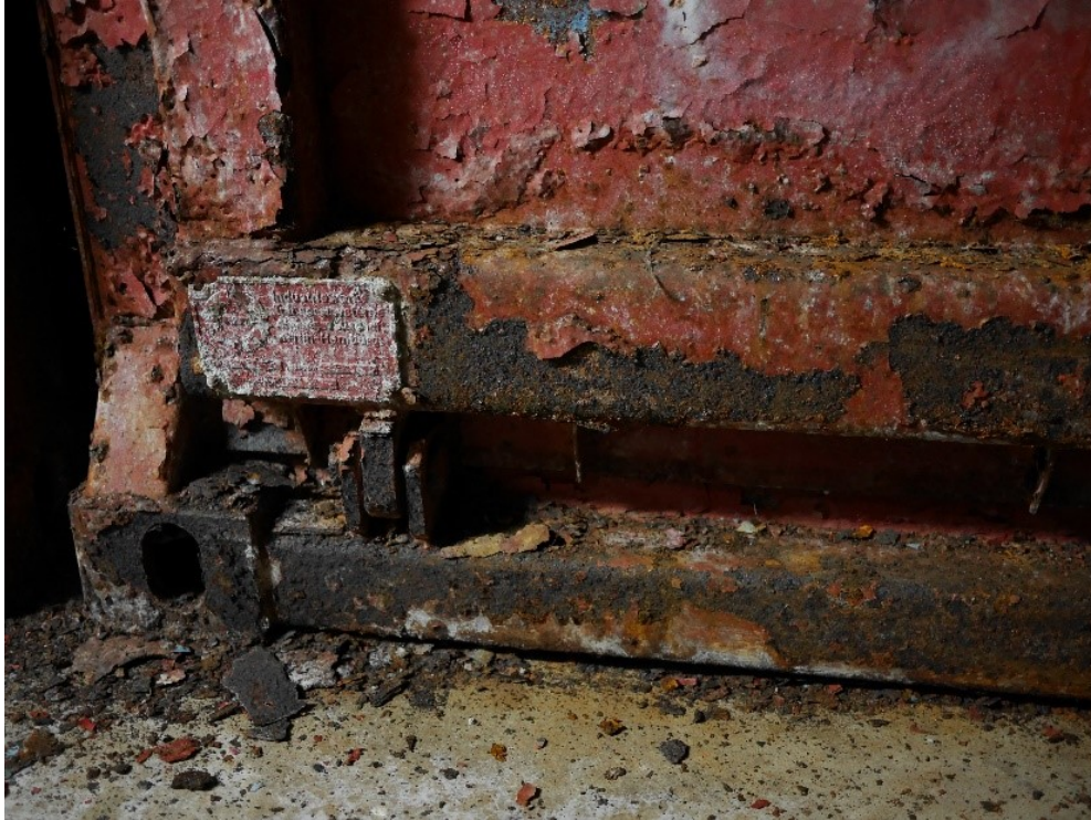
Containern är en av de fyra som SKB har identifierat att vara i särskilt dåligt skick.
